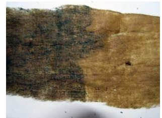
図4：旧裏打ち紙に付着した墨痕
