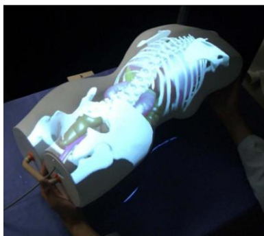
図 3-15 医学教育用トルソ投影システム (出典：投影型トルソディスプレイのための 医学教育コンテンツ)
