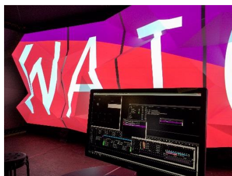
図 2-7 Watchout を使った投影と操作画面 (写真提供 : Dataton)
