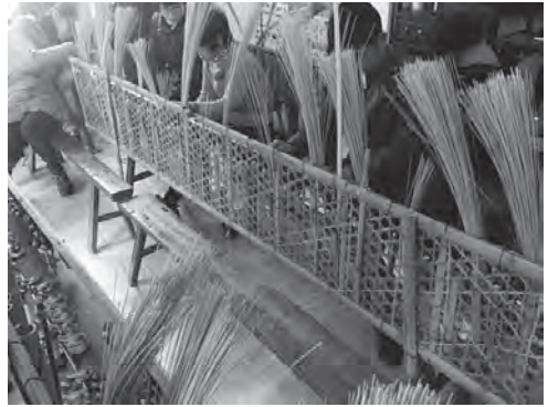
写真10 漉き簀を編む作業
