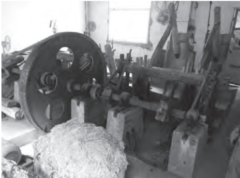
写真9 樹皮を粉碎する機器
