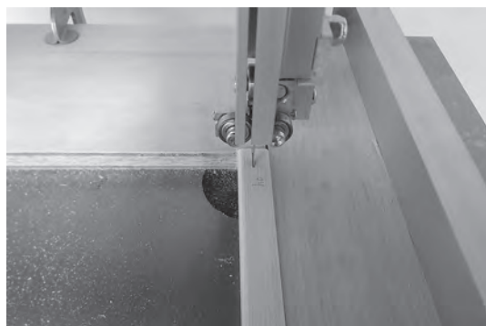
図28 バンドソーで角材へスリット加工
