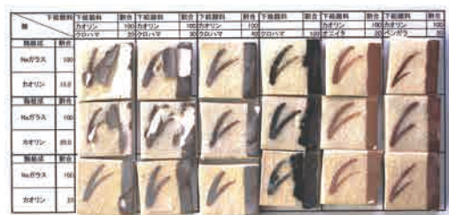
図 23 クロハマ、オニイタ、ベンガラを用いた黒色下絵顔料 (焼付け無、焼成温度 1120℃)
