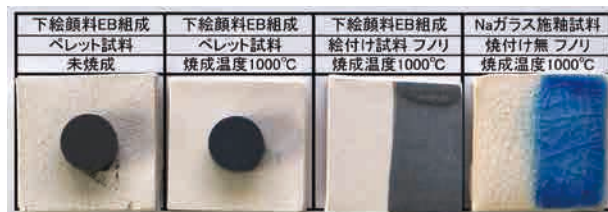
図10 エジブシャンブルー (EB) 組成を下絵顔料に用いた試料の発色 (左から未焼成ペレット試料、1000℃焼成ペレット試料、下絵試料、施釉試料)
