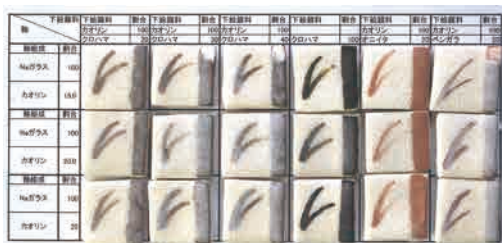
図 22 クロハマ、オニイタ、ベンガラを用いた黒色下絵顔料 (焼き付け温度 1150℃、焼成温度 1120℃)
