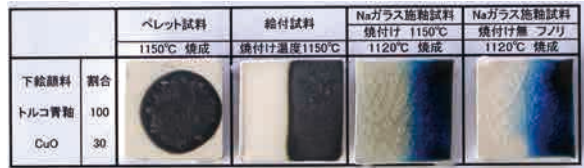
図8 トルコ青釉顔料に CuO を 30% (外割) 添加した下絵顔料の発色 (左からペレット試料、絵付試料、下絵焼付け無施釉試料)
