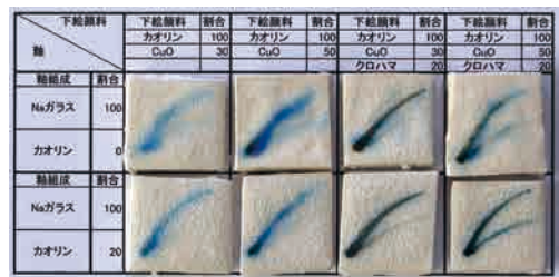
図9 下絵顔料にカオリン、酸化銅、クロハマを用いた試料の発色 (下絵顔料の焼き付け温度 1150℃、施釉試料 1120℃)
