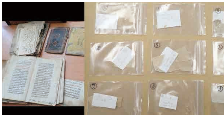
写真16、サマルカンド紙の紙質分析は、修復の際にできる破損部分や繊維の抜き取りにより実施した。
