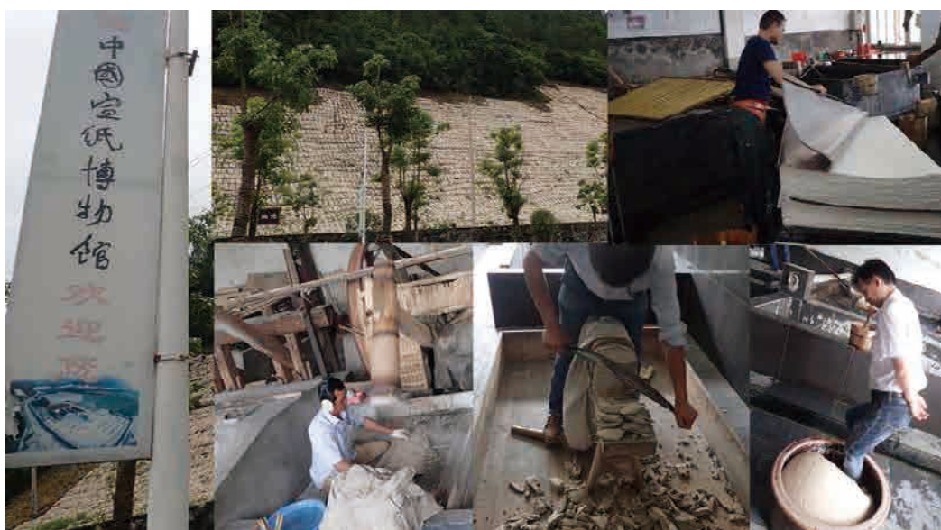
写真18、小嶺村宣紙工場、安徽省宣城宣紙博物館にて宣紙の視察。強力な打ち込みによる公開と断裁により繊維を取り出す。
