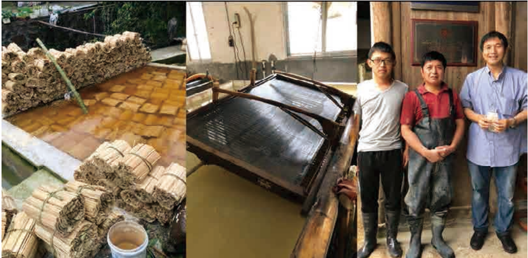
写真 19、杭州市富阳区大同村 朱中華氏の竹紙の作業工程。竹は孟宗竹を使用し、長期間石灰をまぶし浸水させ、腐食の工程を経て煮熟し、機械にて長時間叩解する。
