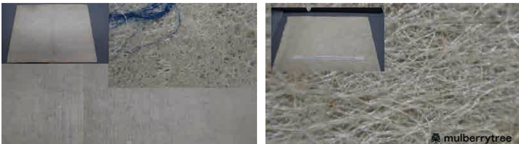
写真3、18世紀のサマルカンド紙(左)の紙質調査では繊維に原料は綿(コットン)でありフェブリル化が見られる。桑によるコンギルメロス工房の紙(右)は、比較的繊維が縮れることなく絡み合っている。
