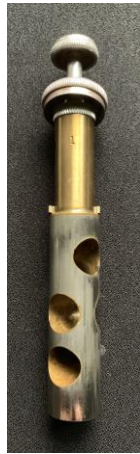
図 18 現在使用されているピストンは、バネが内蔵されている。
