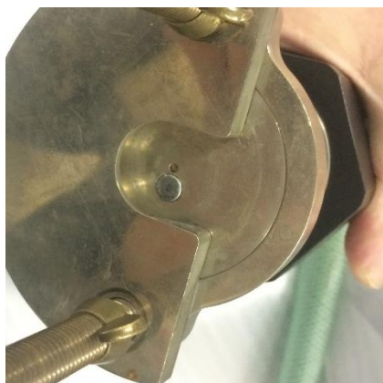
図 22 楽器のマウスピースに接続する部分。 真ん中の小さな穴から様々な周波数の音波を照射する。
