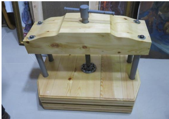
図 4-16 圧搾機 漉いた紙を挟み、圧縮して水をきる道具
