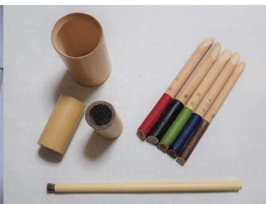
少量の箔を散らす時の箔筒とたたき筆
