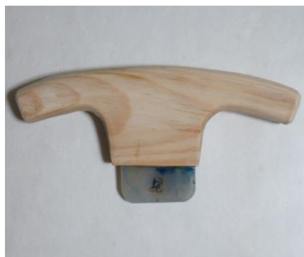
図 4-26 ムフレ。木の柄を手で持ち、石の部分で紙を磨く
