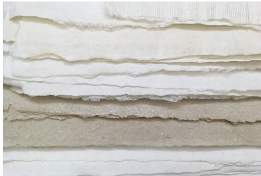
図 4-20 ホーレンダービーターで試作した紙 (試作、撮影/浦野友理氏)
