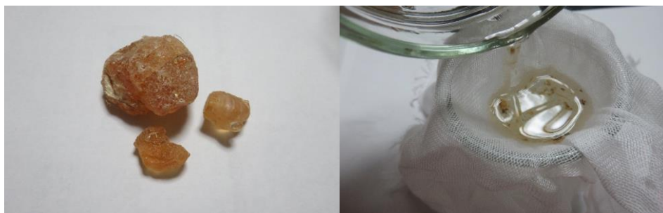
図 4-29 アラビアゴム。水に1～2日浸すと透明な液体となるので、ガーゼで濾して不純物を取り除いて使う
