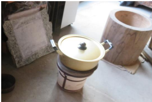
図 4-21 鍋で原料を煮て、木臼で叩解し、石板に張って乾燥させる
