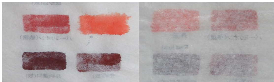
図 4-40 紙の裏面 左図はサイジングができていないため裏面に絵具が浸透し、右図はサイジングができていない状態
