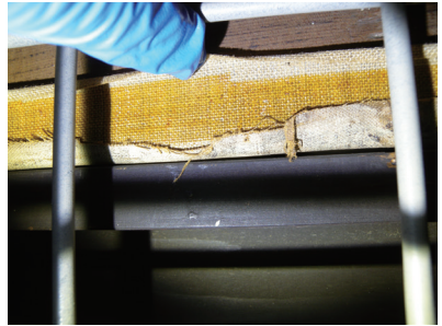
図2 接着剤が変色し裏打ち布が剥がれている
