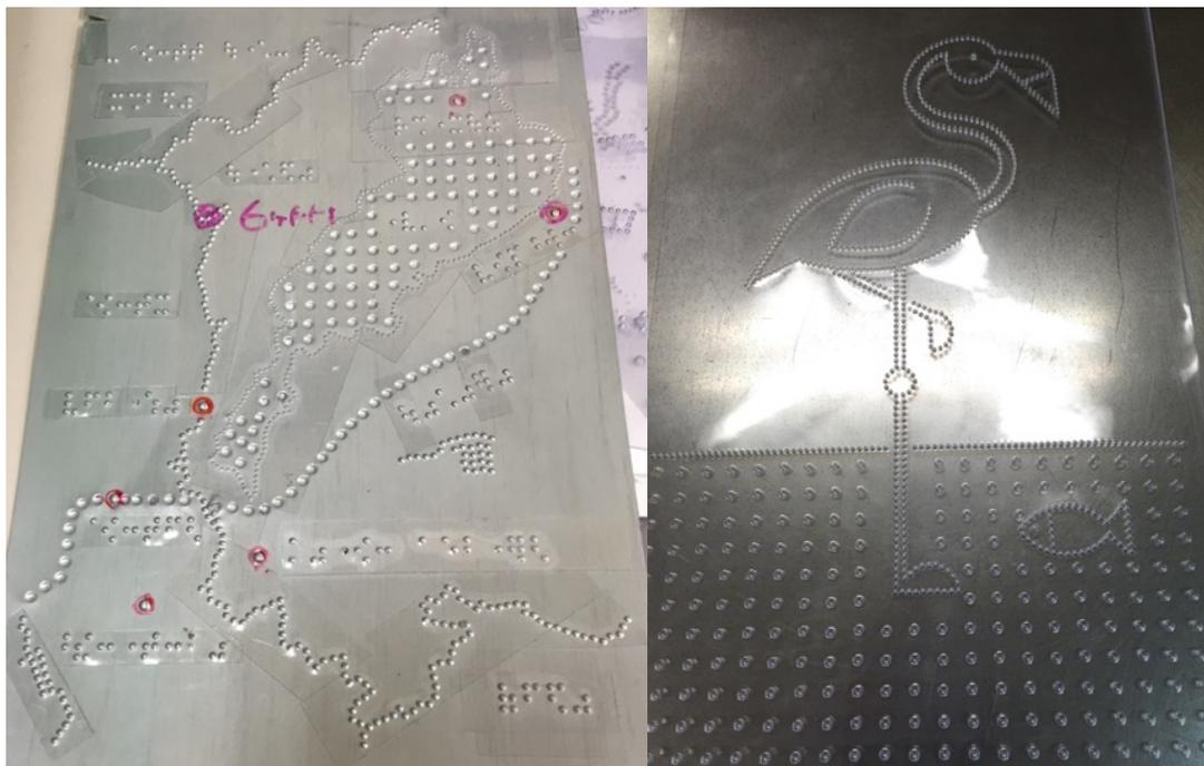
図 18 エンボス印刷・亜鉛板（左）、塩化ビニール板（右）
