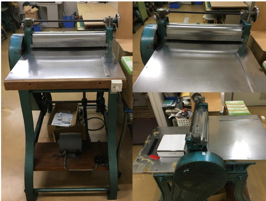
図 67 点字印刷機
