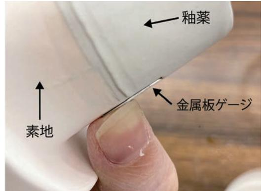
図6 釉薬の厚み計測
